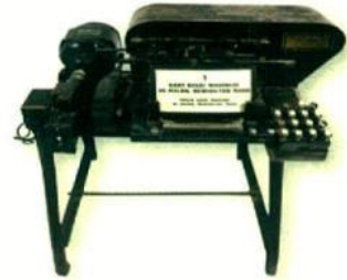
45 Kolonlu Remington Rand 1911-1921 yılları arasında üretilen delgi makinesi Devlet İstatistik Enstitüsü'nde (DİE) uzun yıllar nüfus sayımlarında kullanıldı.
