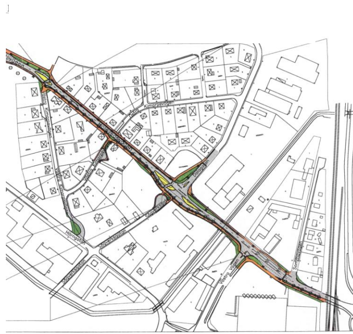
Yerel yollarla (üç üç-ayaklı kavşak) yaya kaldırımlı ve iki yaya geçitli (sarı adalar) yaya sistemi ile (kahverengi çizgiler) bağlantıyı gösteren plan
