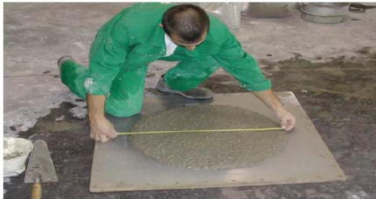
Resim 6.3. Çökme-Yayılma testinde yayılmanın ölçülmesi
