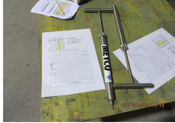
Resim 9.3 Penetrasyon İğnesi Uygulaması
