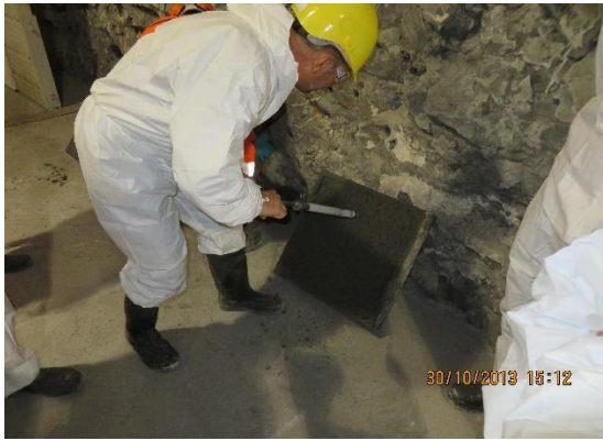
Resim 9.3 Penetrasyon İğnesi Uygulaması
