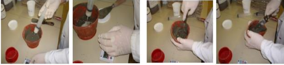
Resim 9.19 Priz Hızlandırıcı Katkının Karışıma İlave Edilmesi
