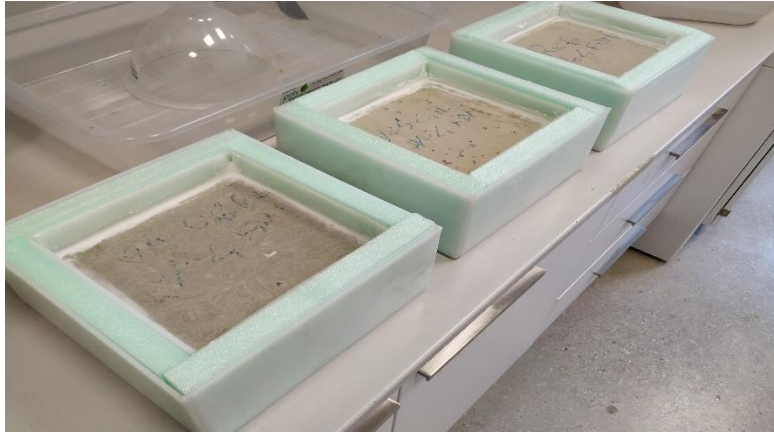
Resim 7.2 Donma-çözülme deneyinde kullanılan düzenek
