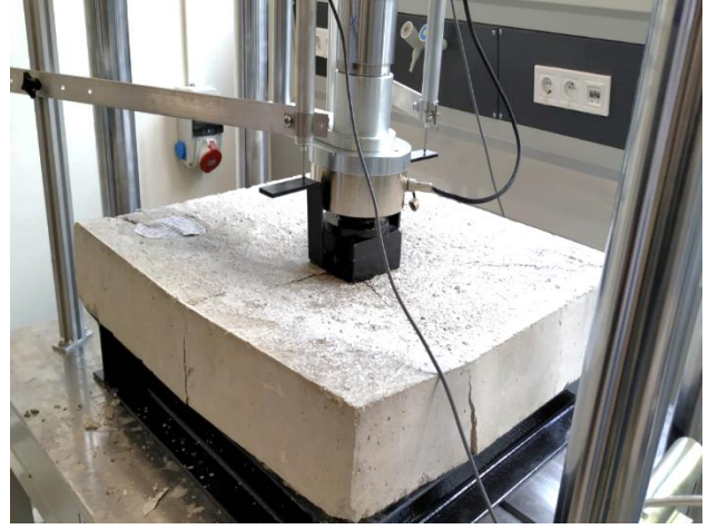
Resim 9.13 Deney numunesinin yükleme düzeneği
