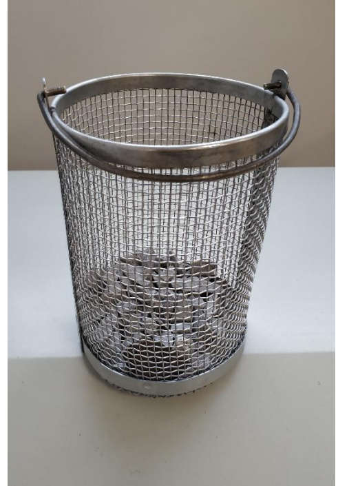
Resim 1.16 – Magnezyum Sülfat Deneyinde Kullanılan Sepet Örneği
