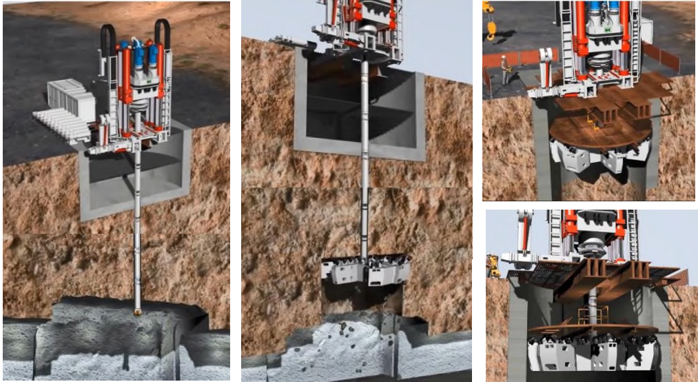
Yeni Zigana Tüneli havalandırma bacalarının imalatında uygulanan Başüstü Delgi Yöntemi'nin şematik gösterimi
