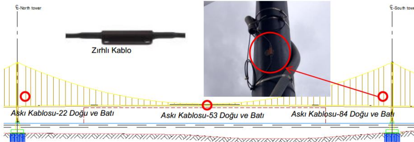
Fig.-2.8 Askı Kablosu Fiber Optik Sıcaklık Sensörü (HT)
