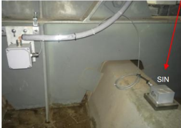
Fig.- 2.22 Dinamik ve Statik Eğim Ölçer Lokasyonları
