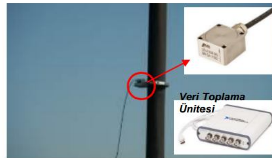
Fig.- 2.26 Mobil İvme Ölçerler İçin Soket Lokasyonları ve Mobil İvme Ölçer
