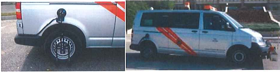
Resim 1: Ses Şiddeti Ölçüm Cihazı [On-Board Sound Intensity (OBSI)]
