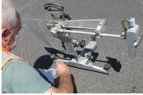
Şekil 9. Kaplama yüzeyinde İngiliz Pandülü ile yapılan BPN ölçümleri.
