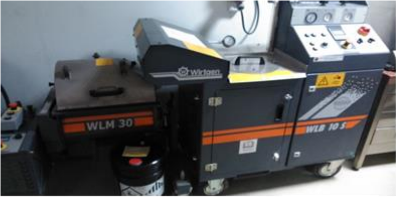
Şekil 2. Köpük bitümle soğuk karışım laboratuvar plenti (Wirtgen)
