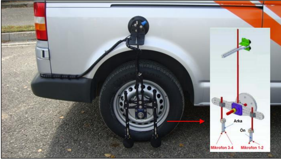
Şekil 18: KGM Bünyesinde Bulunan Gürültü Seviyesi Ölçüm Cihazı (OBSI)
