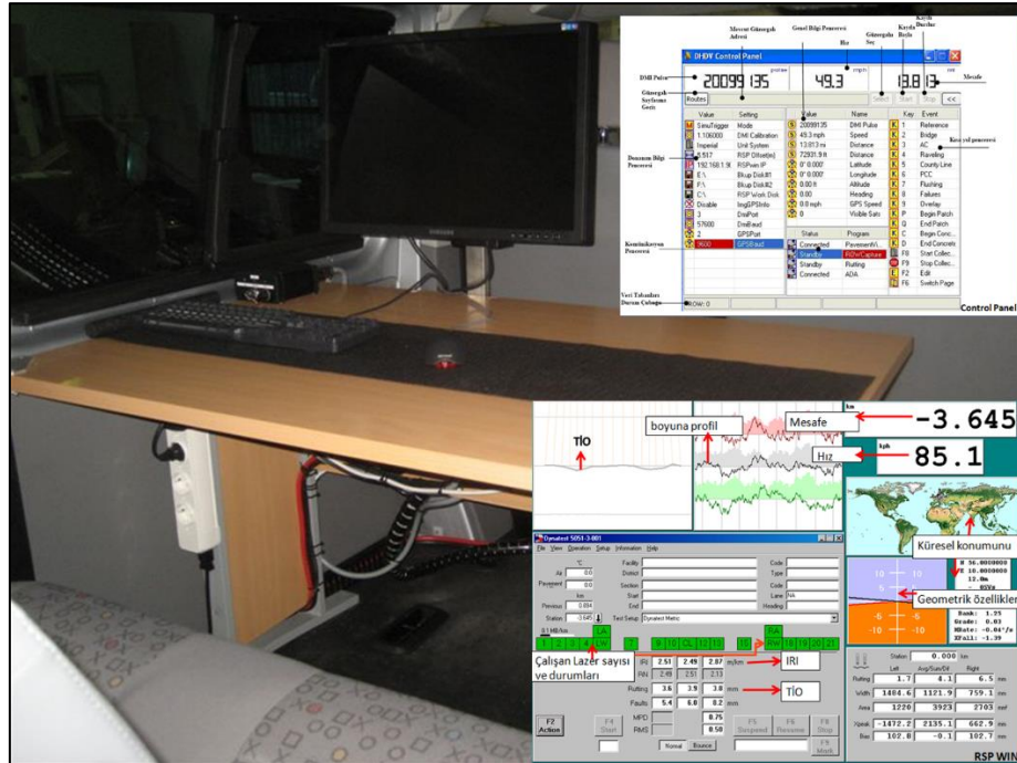
Şekil 12: Profilometre Ölçüm Cihazı İç Donanımı ve Ölçüm Ekranı Örneği
