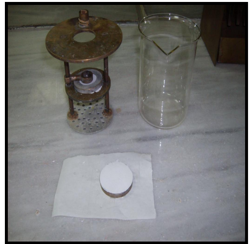
TS EN 1871 Standardına göre (Wilhelmi Yöntemi) Yumuşama Noktası Tayini
