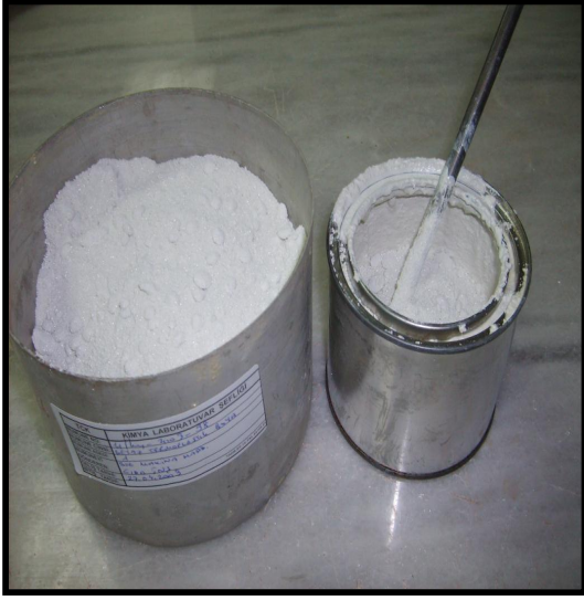
Termoplastik Yol Çizgi Boyası Numunesinde Akma Tayini
