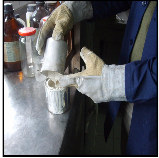
Termoplastik Yol Çizgi Boyası Numunesinde Akma Tayini
