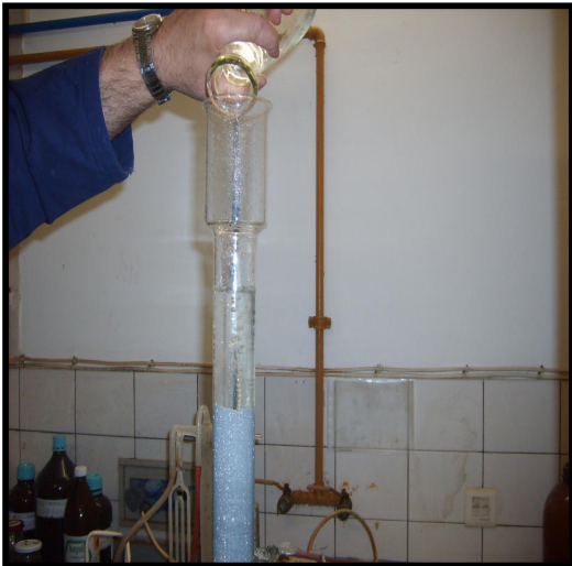
Yol Çizgi Boyası Numunesinde Beyaz Pigment ( TiO_2 )Tayini
