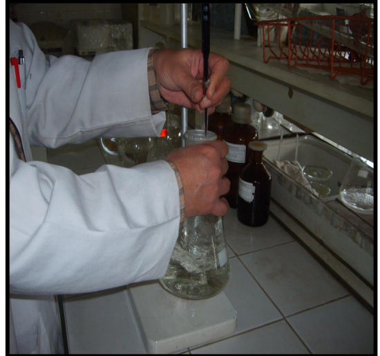
Yol Çizgi Boyası Numunesinde Beyaz Pigment ( TiO_2 )Tayini
