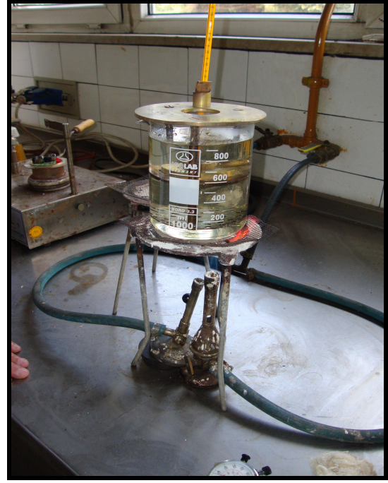
Termoplastik Boyada Yumuşama Noktası Tayin Düzeneği
