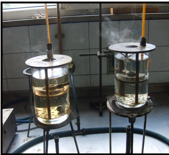
TS EN 1871 Standardına göre (Wilhelmi Yöntemi) Yumuşama Noktası Tayini
