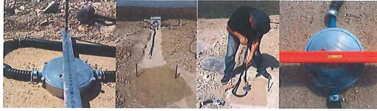
Şekil 7. Toprak basınç sensörleri (Sensör Yüzeyi: Taban Zemini - 10mm)
