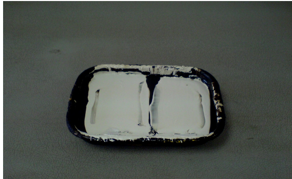
Sızmaya karşı dayanım için bitüm üzerine çekilmiş boya filmi
