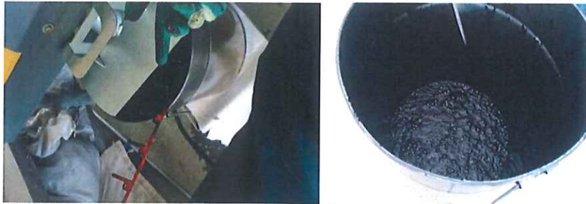
Şekil 3.1. Bitümün köpürtülmesi ve köpürdükten sonra sönmüş bitüm görünümü
