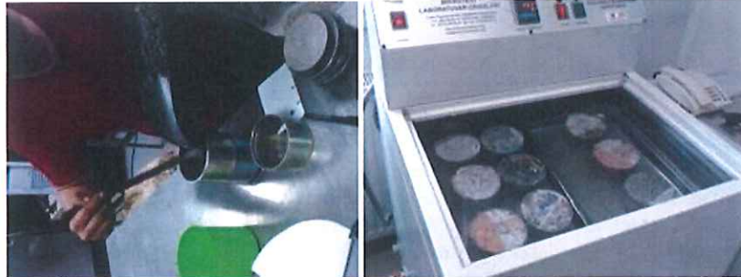
Şekil 3.4. İÇM briketlerinin hazırlanışı ve briketlerin su banyosunda şartlandırılması
