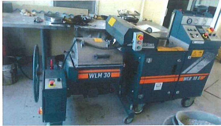
Şekil 3.3. Köpük asfalt laboratuvar plenti ile köpük asfalt üretimi
