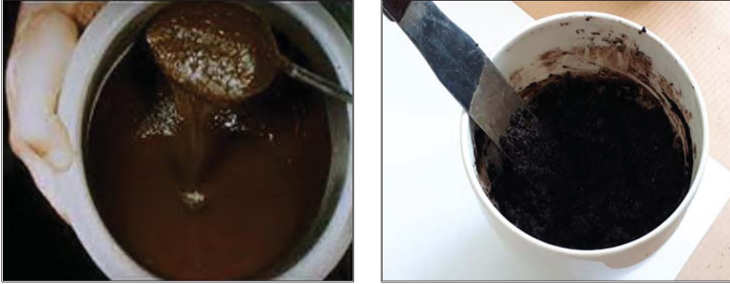
řekil 6.14. Bit m Em lsiyonlu Slurry Seal Harcının Karıştırmaya S resi Tayini
