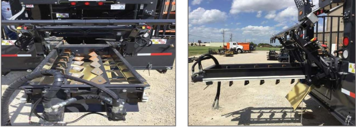
Şekil 6.21. Harç Tipi Kaplama Makinesinin Sürekli Akışlı Karıştırma Ünitesi
