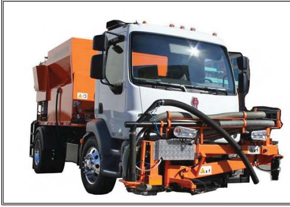
Şekil 5.13. Püskürtme Enjeksiyonlu Yama Kamyonu
