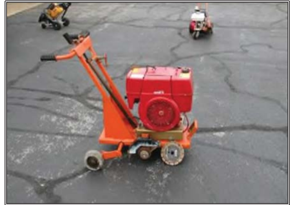
Şekil 5.1. Dikey Milli Yönlendirici ve R-C Testeresi
