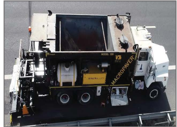
Şekil 6.20. Sürekli Çalışabilen Tipte ve Kamyonu Monteli Tipte Harç Tipi Kaplama Makineleri
