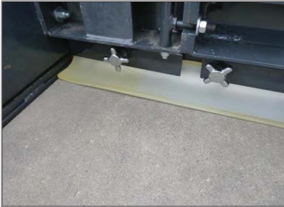
Şekil 6.24. Slurry Seal Yayma Kutusunda Esnek Sıyırma Aparatı ve Kumaş Uygulaması
