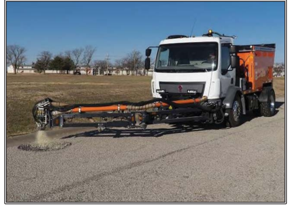
Şekil 5.13. Püskürtme Enjeksiyonlu Yama Kamyonu
