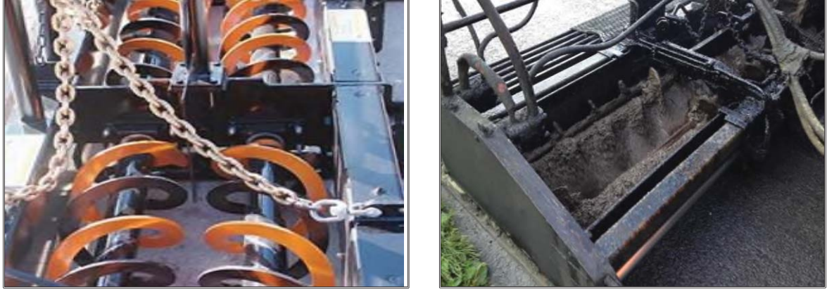
Şekil 6.26. Micro Surfacing Uygulamasında Kullanılan Spiral Helezonlu Yayma Kutusu
