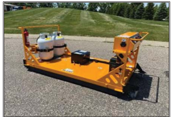
Şekil 5.14. İnfrared Isıtıcı Yama Uygulaması
