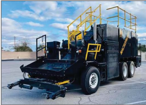
Şekil 6.20. Sürekli Çalışabilen Tipte ve Kamyonu Monteli Tipte Harç Tipi Kaplama Makineleri
