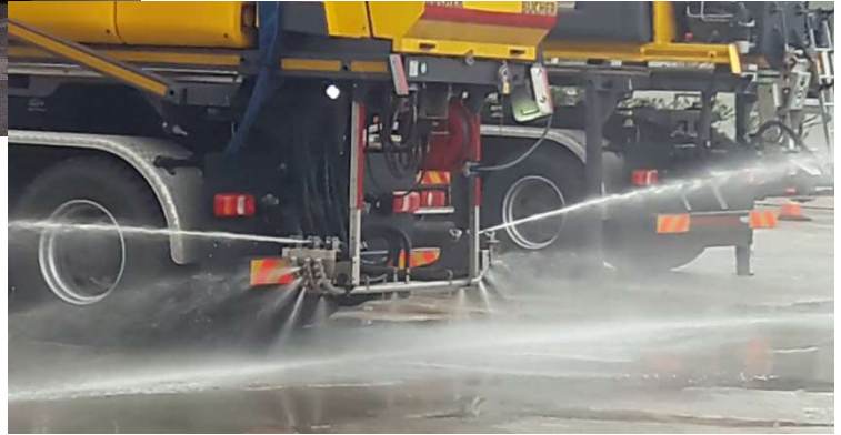
Resim 16. Kamyon arkası sıvı tankı ve çözelti püskürtme sistemi
