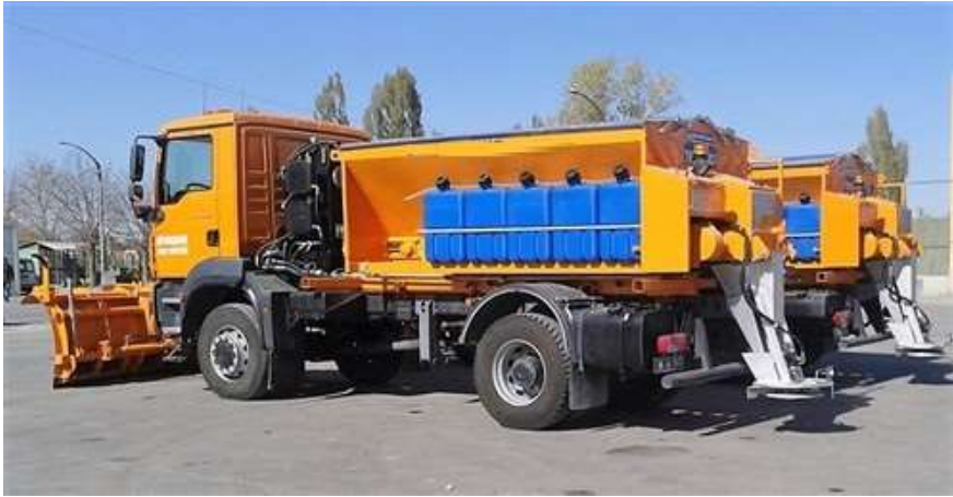
Resim 11. Kuru ve Ön Islatılmış Tuz Serici
