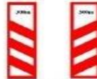
DEMİRYOLU GEÇİDİ YAKLAŞIM LEVHALARI (Sol - Sağ)
