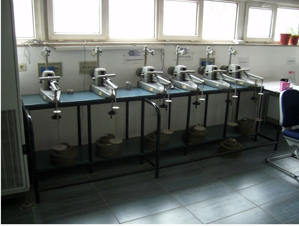
ZEMİN MEKANİĞİ LABORATUVARI, KONSOLIDASYON DENEYİ CİHAZLARI
