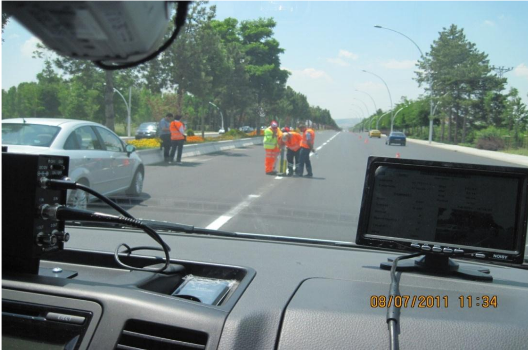
FİZİK LABORATUVARI, YOL ÇİZGİ BOYASI MOBİL GERİ YANSITMA (GECE GÖRÜNÜRLÜĞÜ) TEST ÖLÇÜM SİSTEMİ
