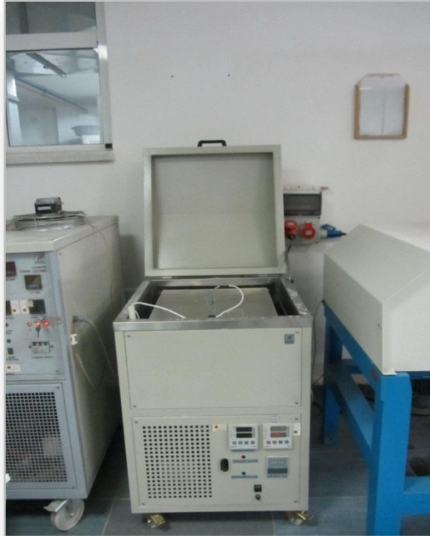
BETON LABORATUVARI, NORDİK DENEY CİHAZI
