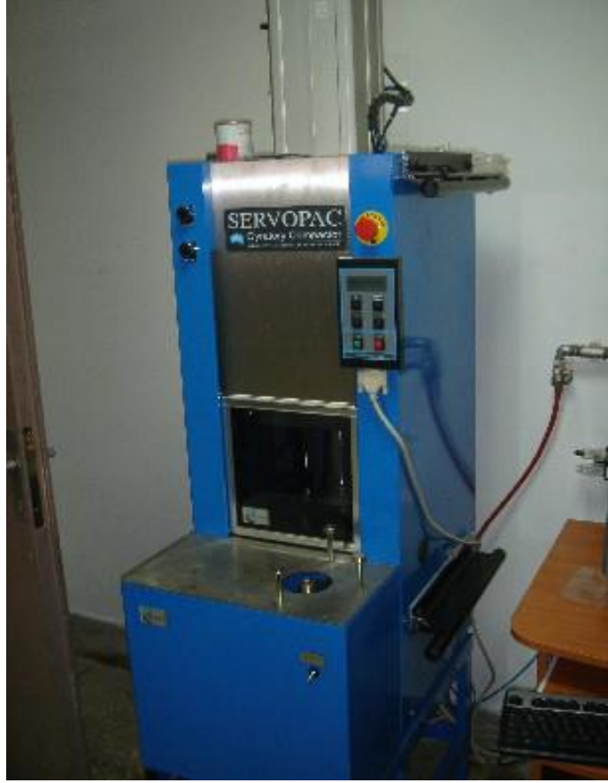
BİTÜMLÜ KARIŞIMLAR LABORATUVARI, YOĞURMALI KOMPAKTÖR DENEY CİHAZI
