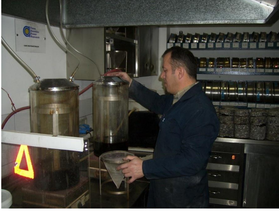
BİTÜMLÜ KARIŞIMLAR LABORATUVARI, BİTÜM MİKTARI TAYİNİ DENEYİ (CAM EKSTRAKTÖR)
