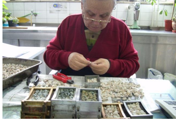
BITÜMLÜ KARIŞIMLAR LABORATUVARI, CİLANMA DEĞERİ TAYİNİ DENEYİ İÇİN NUMUNE HAZIRLANMASI
