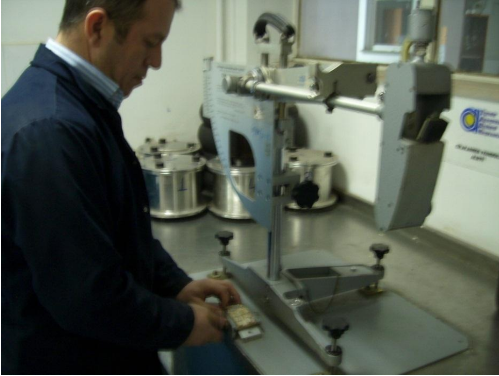
BITÜMLÜ KARIŞIMLAR LABORATUVARI, CİLANMA DEĞERİ TAYİNİ DENEY ÇALIŞMASI
