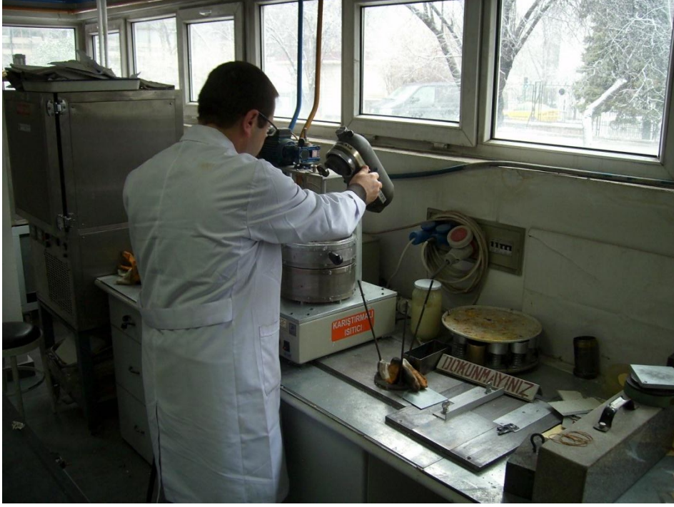
FİZİK LABORATUVARI, TERMOPLASTİK YOL ÇİZGİ BOYASI DENEYİ
