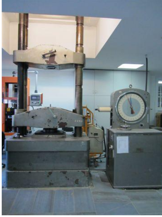
MEKANİK LABORATUVARI, 180 TON KAPASİTELİ ÇEKME BASMA TEST PRESİ
