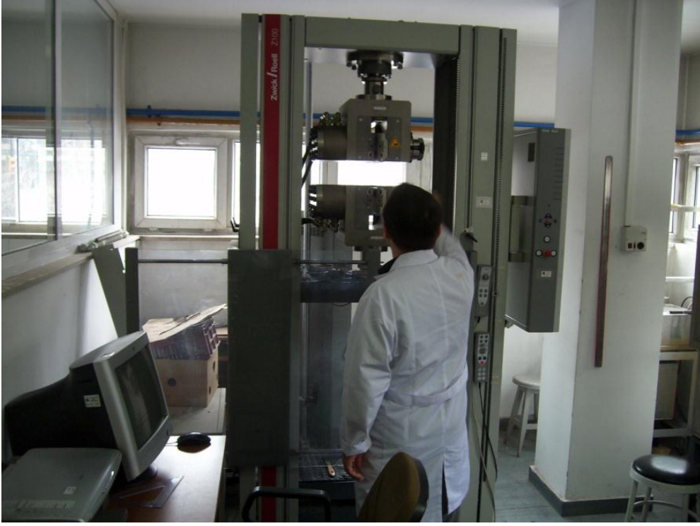
FİZİK LABORATUVARI, ÇİFT KABİNLİ 4 AYRI YÜK HÜCRELİ (500N ,20KN,50KN,100KN) ÇEKME DENEYİ
