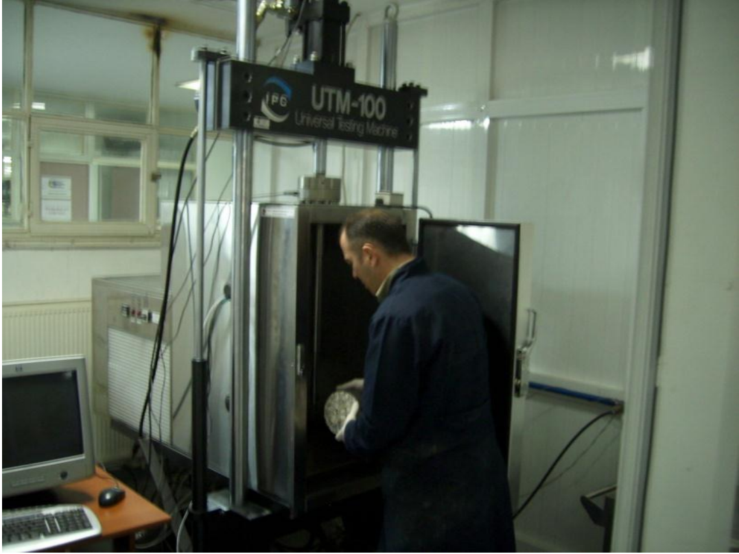
BİTÜMLÜ KARIŐIMLAR LABORATUVARI, ESNEKLİK MODÜLÜ TAYİNİ DENEY ÇALIŐMASI
