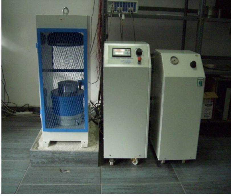
KAYA MEKANIĐİ LABORATUVARI, ÜÇ EKSENLİ BASMA DAYANIMI DENEY CİHAZI
