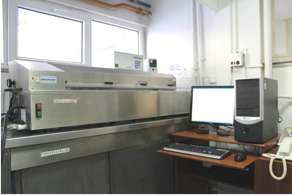
BİTÜM LABORATUVARI, KUVVET ÖLÇÜMLÜ DÜKTİLİTE DENEY CİHAZI
