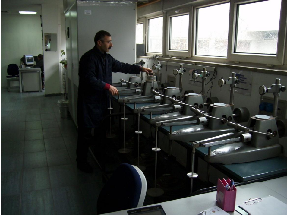
ZEMİN MEKANİĞİ LABORATUVARI, KONSOLIDASYON DENEYİ
