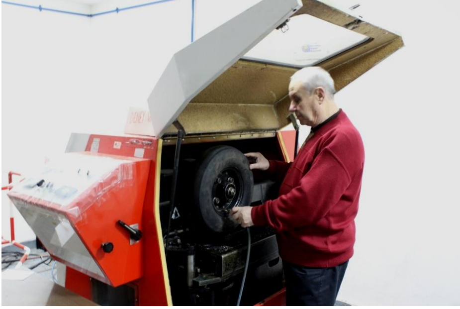
BİTÜMLÜ KARIŞIMLAR LABORATUVARI, TEKERLEK İZİNDE OTURMA DENEY ÇALIŞMASI
