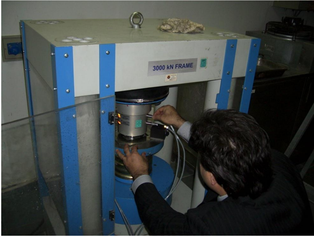
KALİBRASYON LABORATUVARI, BETON PRES KALİBRASYONU
