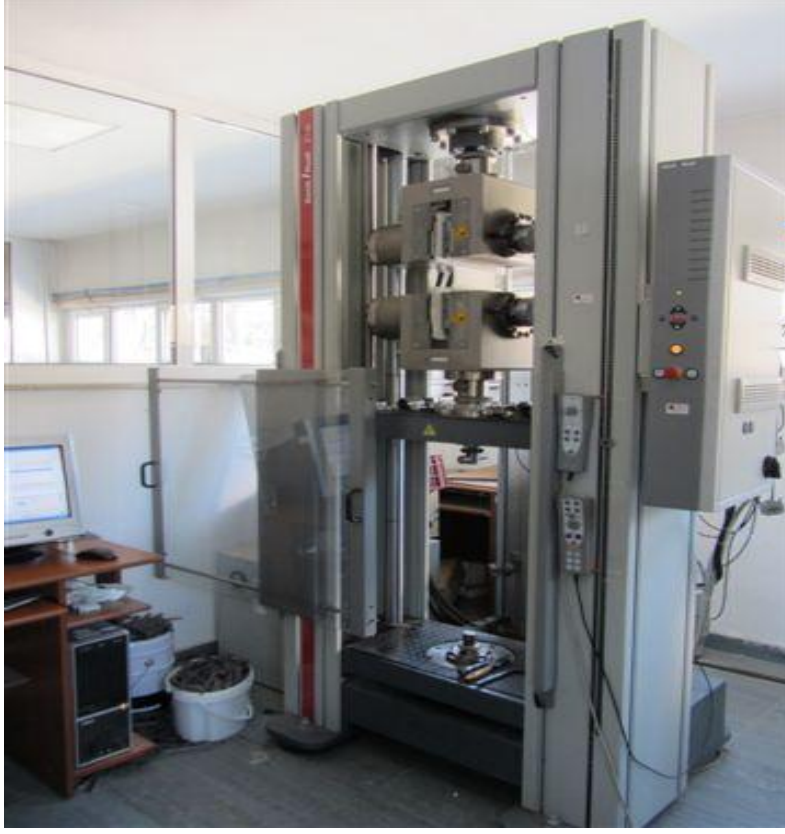
MEKANİK LABORATUVARI, OTOKORKULUK, HAM SAC, ÇELİK ÇEKME, JEOTEKSTİL, JEOMEMBRAN ÇEKME TEST PRESİ
