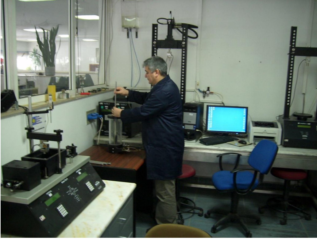
ZEMİN MEKANİĞİ LABORATUVARI, ÜÇ EKSENLİ BASINÇ DENEYİ
