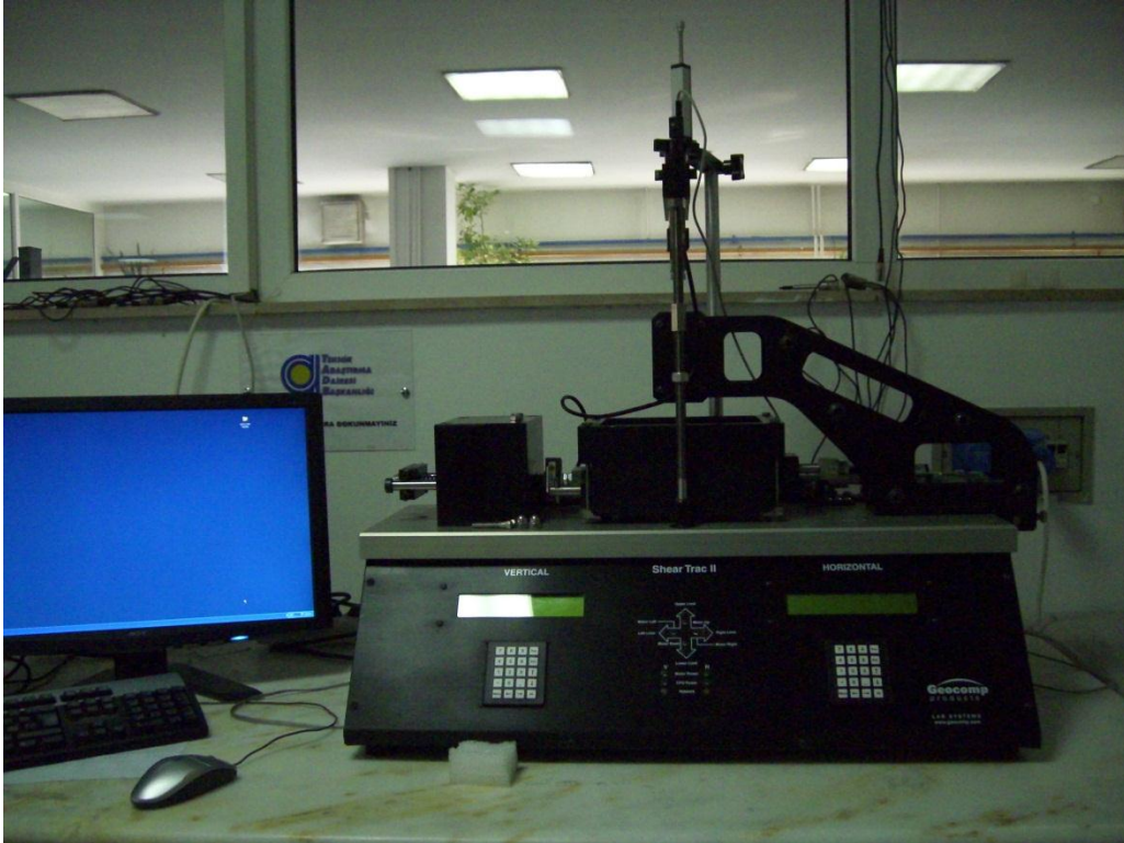
ZEMİN MEKANİĞİ LABORATUVARI, DİREKT KESME DENEY CİHAZI
