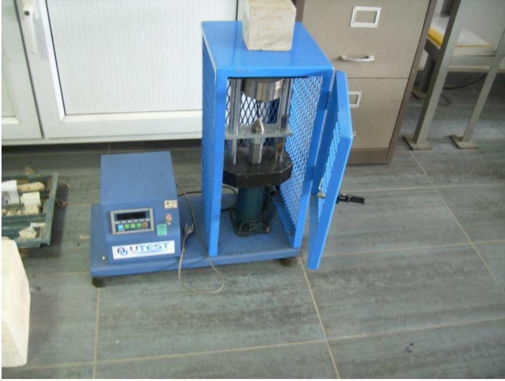
KAYA MEKANİĞİ LABORATUVARI, NOKTA YÜKLEME İNDEKSİ TAYİNİ DENEY CİHAZI
