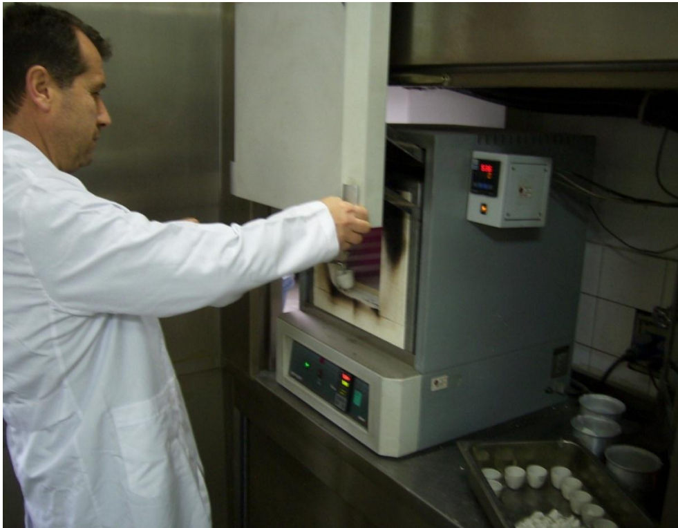
KİMYA LABORATUVARI, TERMOPLASTİK YOL ÇİZGİ BOYASINDA BAĞLAYICI MADDE TAYİNİ DENEYİ
