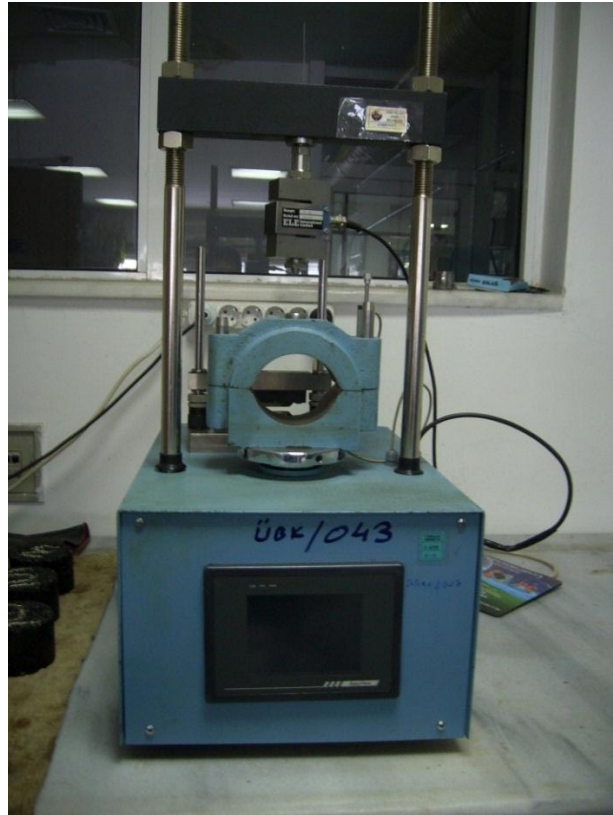
BİTÜMLÜ KARIŞIMLAR LABORATUVARI, MARSHALL STABİLİTE-AKMA DENEY ALETİ
