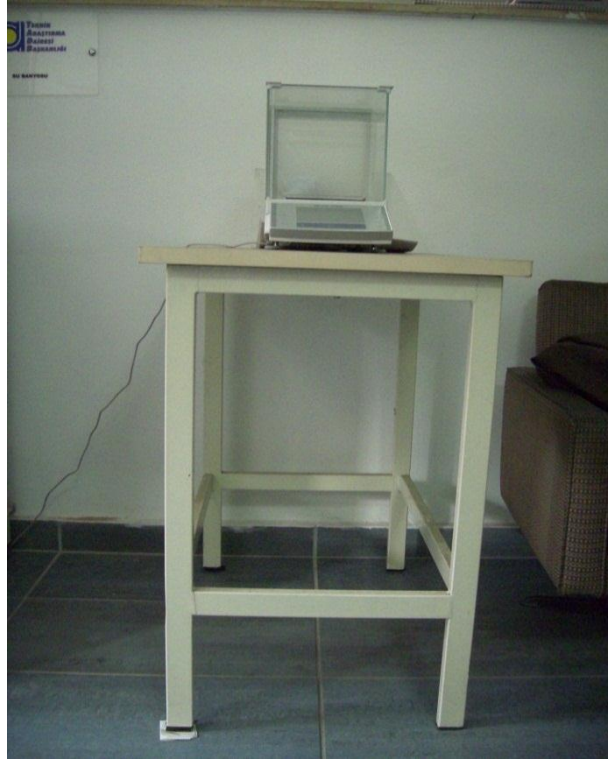
ZEMİN MEKANİĞİ LABORATUVARI, ÖZGÜL AĞIRLIK DENEYİ HASSAS TERAZİSİ
