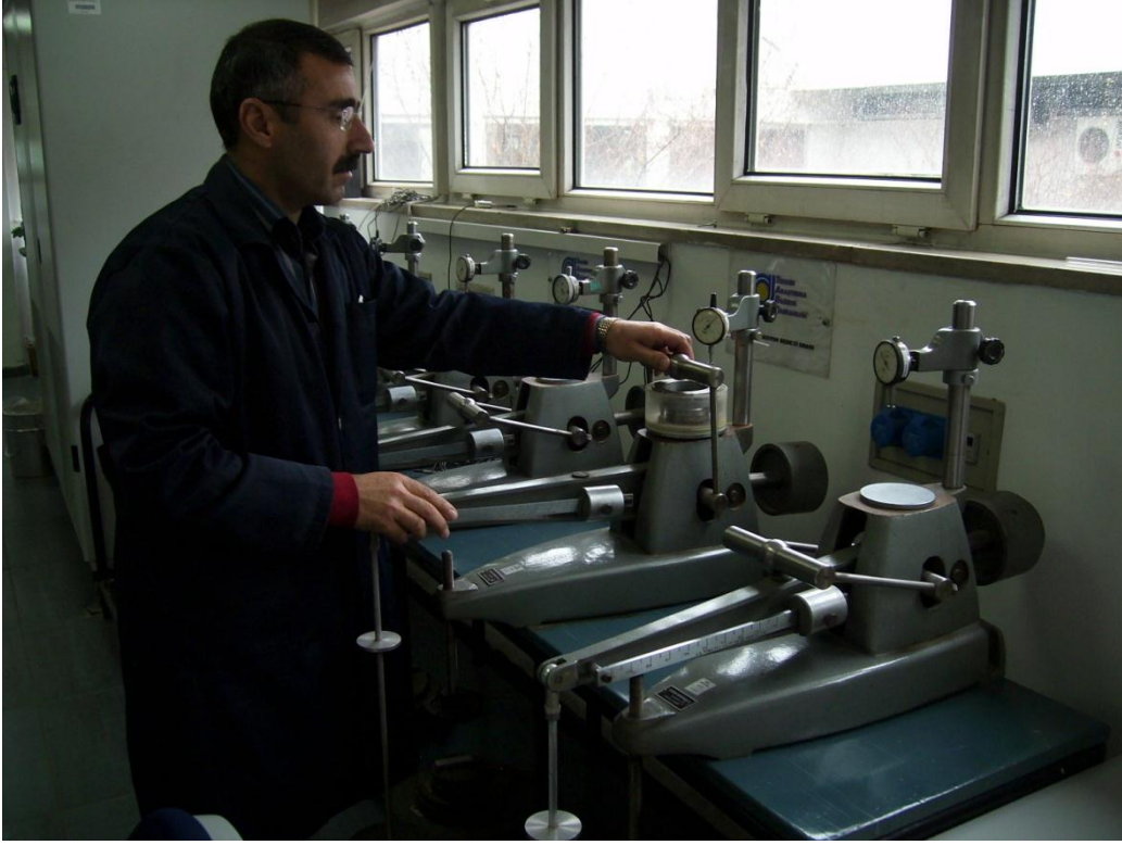
ZEMİN MEKANİĞİ LABORATUVARI, ŞİŞME YÜZDESİ DENEYİ
