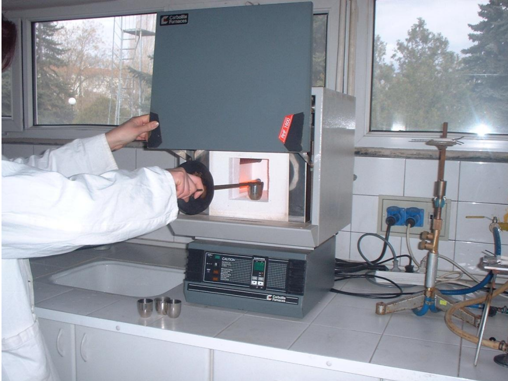
KİMYA LABORATUVARI, SUDA SÜLFAT TAYİNİ DENEYİ
