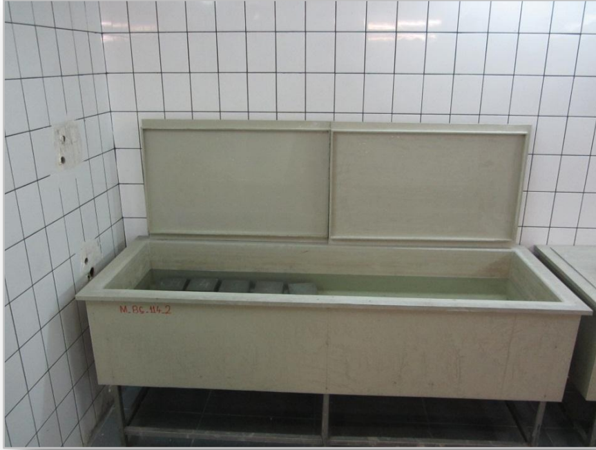
BETON LABORATUVARI, KÜR ODASI
