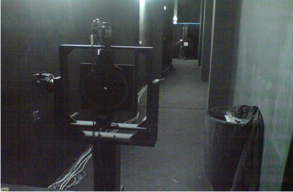
FİZİK LABORATUVARI, REFLEKTİF ÖZELLİKLİ MALZEMELERDE GECE GÖRÜNÜRLÜĞÜ(REFLEKTİVİTE) ÖLÇÜM CİHAZI
