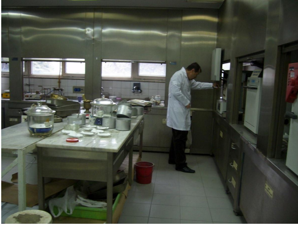
KİMYA LABORATUVARI, SOĞUK YOL ÇİZGİ BOYASINDA BAĞLAYICI MADDE TAYİNİ DENEYİ
