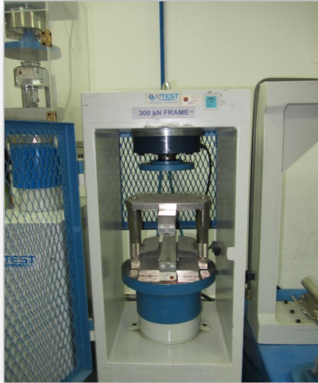
BETON LABORATUVARI, 300 KN'LUK EĞİLMEDE ÇEKME DAYANIMI TEST CİHAZI
