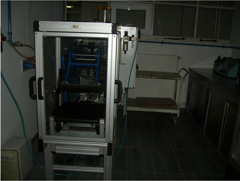
BİTÜMLÜ KARIŞIMLAR LABORATUVARI, TEKRARLI YÜK ALTINDA YORULMAYA DİRENÇ TAYİNİ NUMUNE SIKIŞTIRICI ÜNİTESİ
