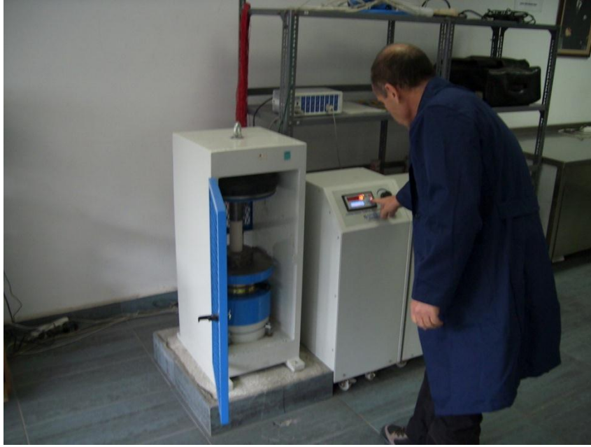
KAYA MEKANIĐI LABORATUVARI, TEK EKSENLI BASMA DAYANIMI DENEYİ
