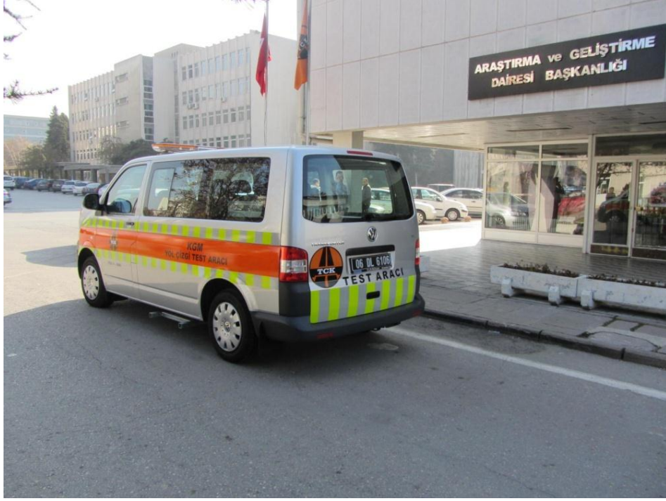
FİZİK LABORATUVARI, YOL ÇİZGİ BOYASINDA GEÇE GÖRÜNÜRLÜĞÜ TEST ARACI
