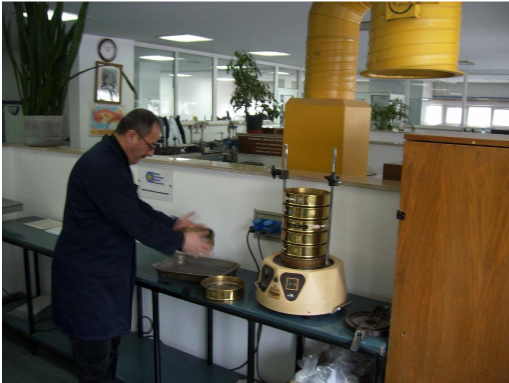
ZEMİN MEKANİĞİ LABORATUVARI, ELEK ANALİZİ DENEYİ
