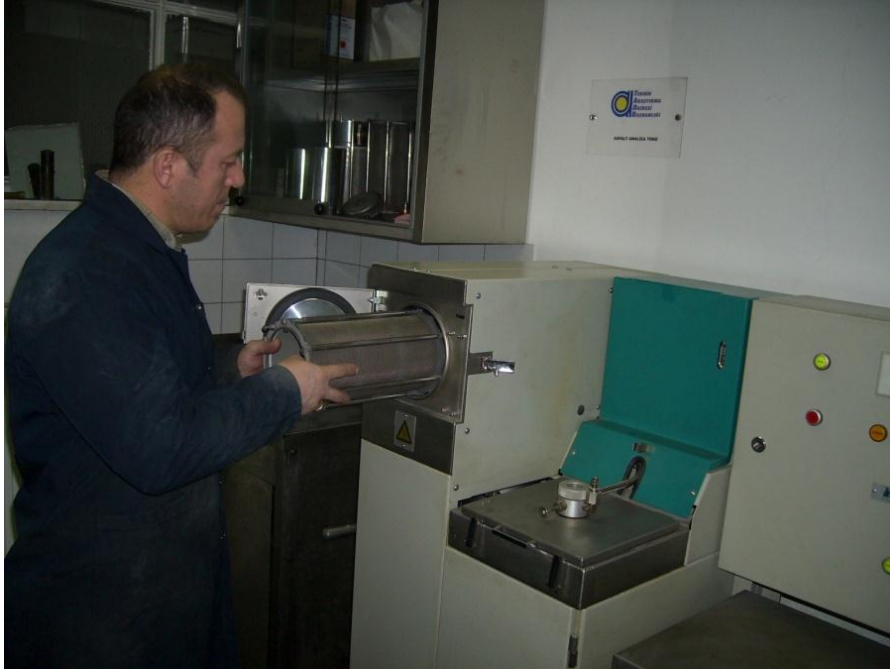
BİTÜMLÜ KARIŞIMLAR LABORATUVARI, BİTÜM MİKTARI TAYİNİ (ASFALT ANALİZATÖRÜ) DENEY ÇALIŞMASI
