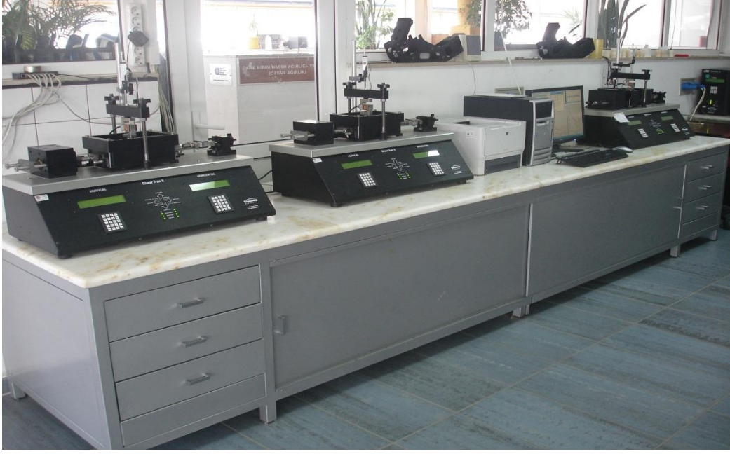
ZEMİN MEKANİĞİ LABORATUVARI, DİREKT KESME DENEY CİHAZI
