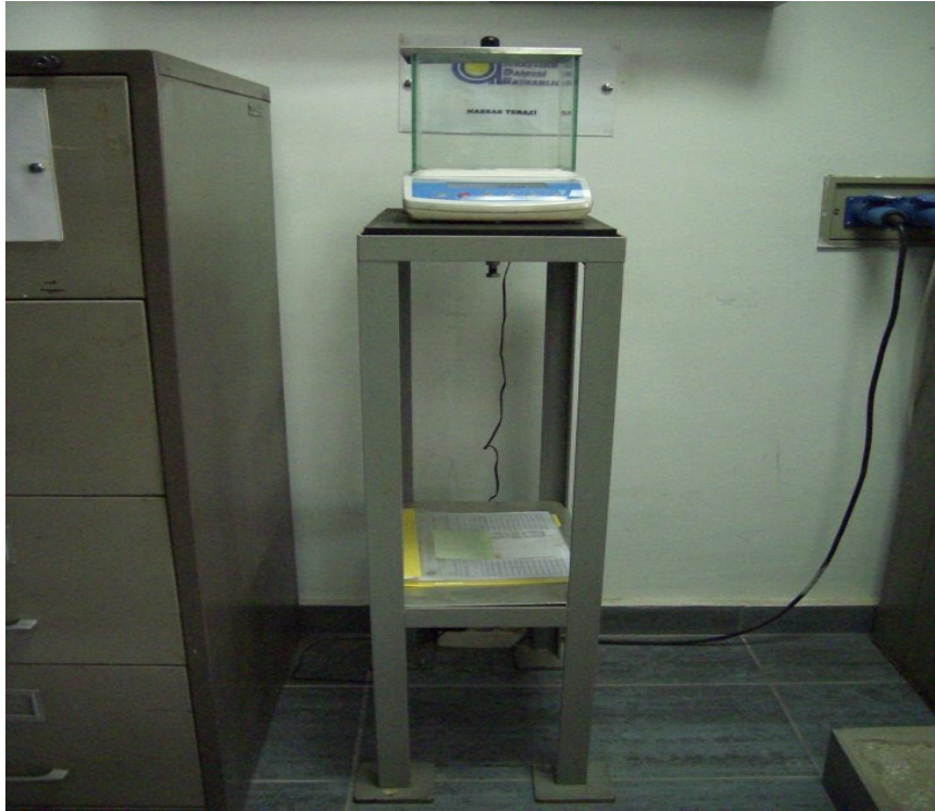
KAYA MEKANİĞİ LABORATUVARI, DENEY NUMUNESİ TARTIM TERAZİSİ
