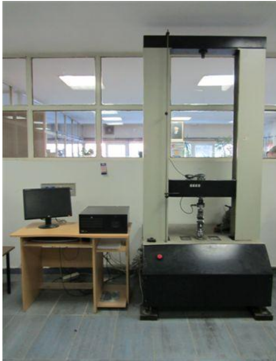
MEKANİK LABORATUVARI, 100 KN'LUK ELASTOMESNET ÇELİK VE KAUÇUK ÇEKME PRESİ
