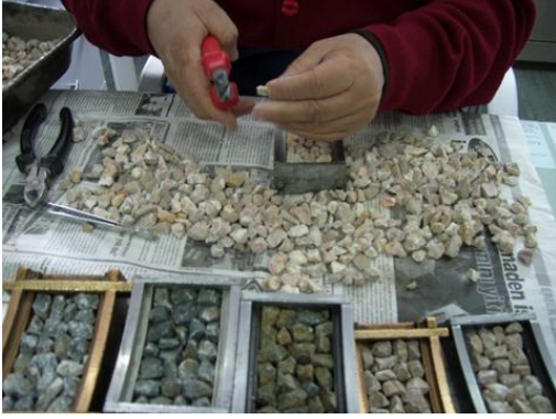
BITÜMLÜ KARIŞIMLAR LABORATUVARI, CİLANMA DEĞERİ TAYİNİ DENEYİ İÇİN NUMUNE HAZIRLANMASI
