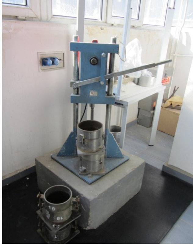
TOPRAK VE STABİLİZASYON LABORATUVARI TİTREŞİMLİ TOKMAK DENEY CİHAZI
