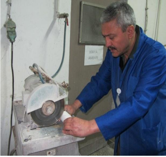
KABA TAŐ NUMUNEDEN NUMUNE ÇIKARMA KESİT İNCELTME ÇALIŐMA
