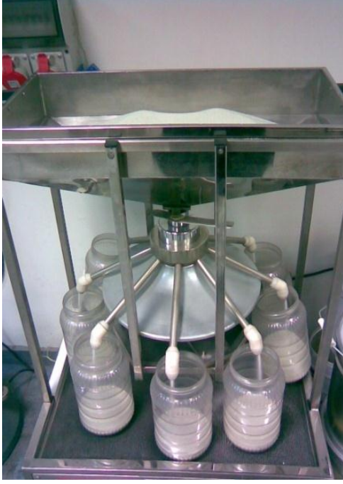
FİZİK LABORATUVARI, CAM KÜRECİK NUMUNE ALMA VE ELEME CİHAZLARI
