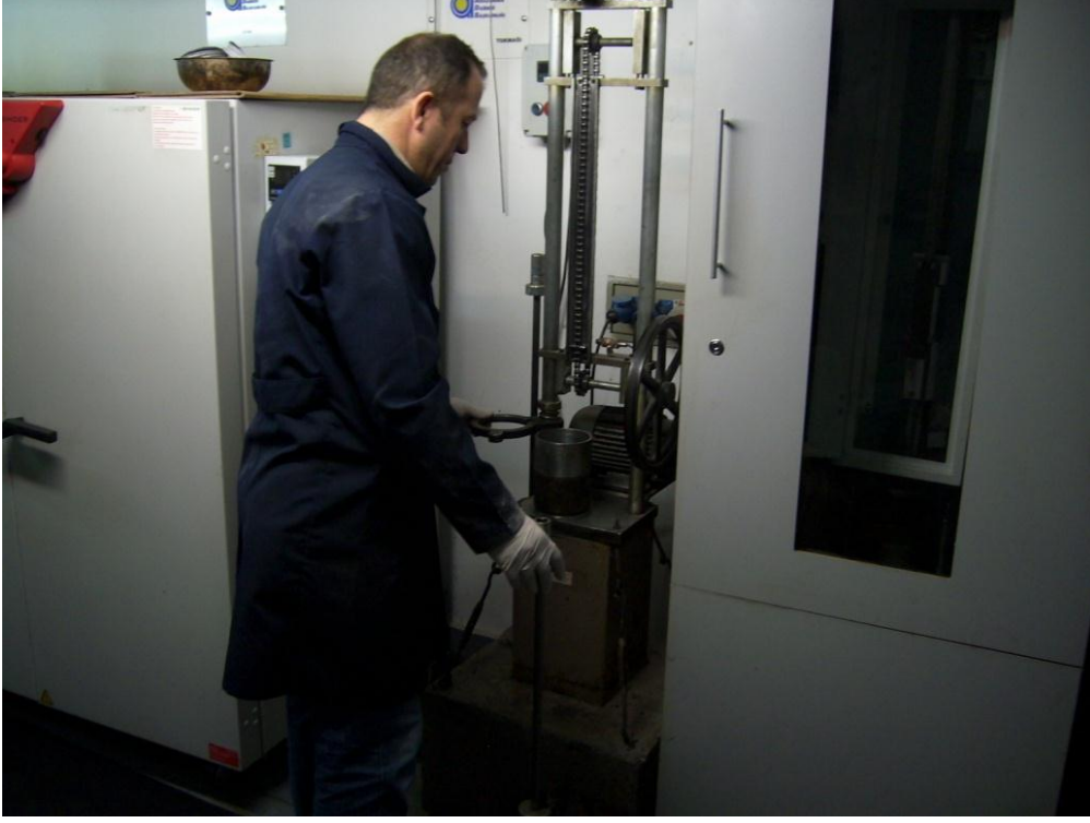
BİTÜMLÜ KARIŞIMLAR LABORATUVARI, MARSHALL DENEYİ ÇALIŞMASI
