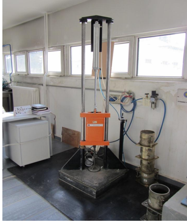
TOPRAK VE STABİLİZASYON LABORATUVARI ESNEKLİK MODÜLÜ SIKIŞTIRMA DENEYİ CİHAZI
