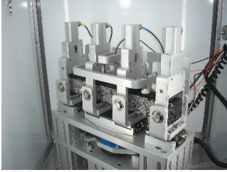
BİTÜMLÜ KARIŞIMLAR LABORATUVARI, TEKRARLI YÜK ALTINDA YORULMAYA DİRENÇ TAYİNİ DENEY CİHAZI (FATİGUE DENEY ALETİ 4-NOKTA)
