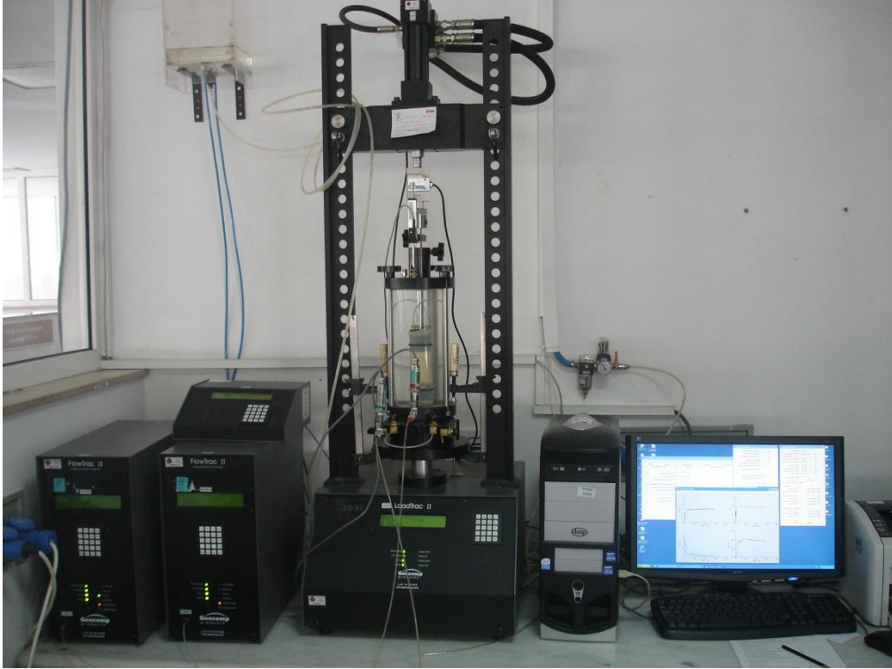
ZEMİN MEKANİĞİ LABORATUVARI, ÜÇ EKSENLİ BASINÇ DENEYİ CİHAZI
