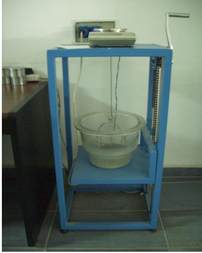
ZEMİN MEKANİĞİ LABORATUVARI, TABİİ BİRİM HACİM AĞIRLIK DENEYİ DÜZENLEĞİ
