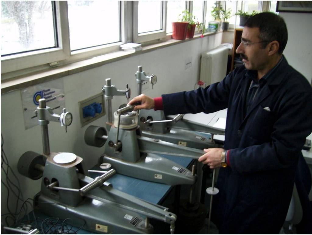
ZEMİN MEKANİĞİ LABORATUVARI, ŞİŞME BASINCI DENEY ÇALIŞMASI
