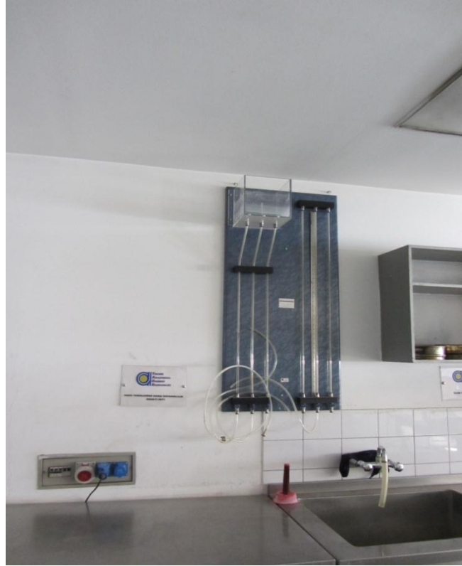
TOPRAK VE STABİLİZASYON LABORATUVARI PERMEABİLİTE DENEY CİHAZI
