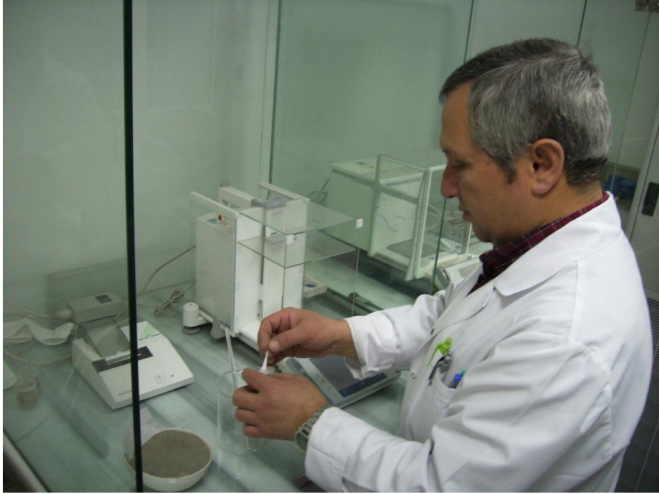
KİMYA LABORATUVARI, BOYADA TİTAN DENEYİ
