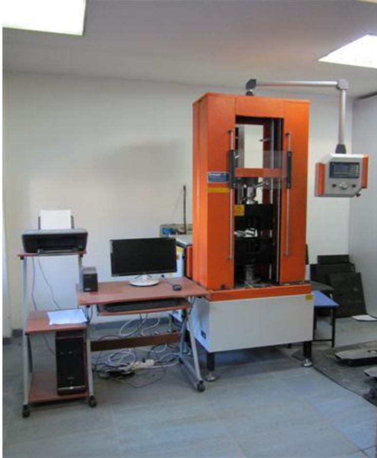
MEKANİK LABORATUVARI, 100KN' LUK ÇELİK ÇEKME TEST CİHAZI
