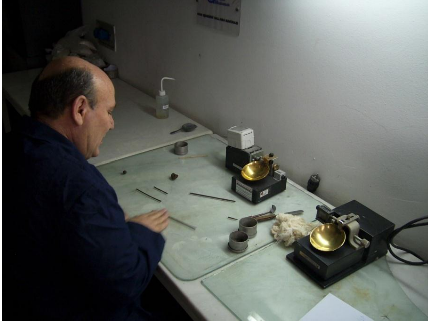
TOPRAK VE STABİLİZASYON LABORATUVARI PLASTİK LİMİT DENEYİ ÇALIŞMASI
