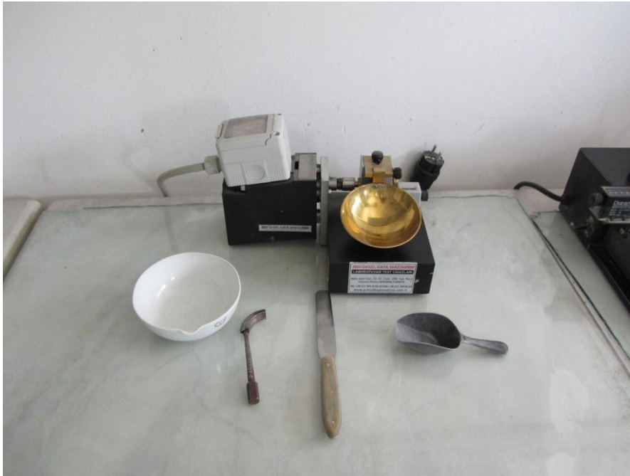
TOPRAK VE STABİLİZASYON LABORATUVARI LİKİT LİMİT DENEYİ CİHAZLARI
