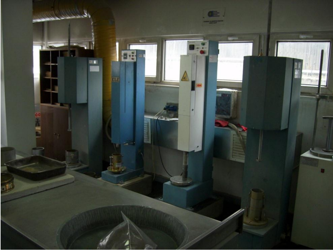
TOPRAK VE STABİLİZASYON LABORATUVARI OTOMATİK KOMPAKTÖR (STANDART-MODİFİYE PROKTOR) DENEY CİHAZI
