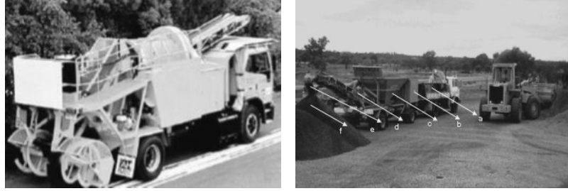
Şekil 4. Agregaları Yerinde Önceden Bitümle Kaplama İşleminde Kullanılan Farklı İki Sistem (Gransberg D. and James D.M.B. 2005, Web Site 2).
