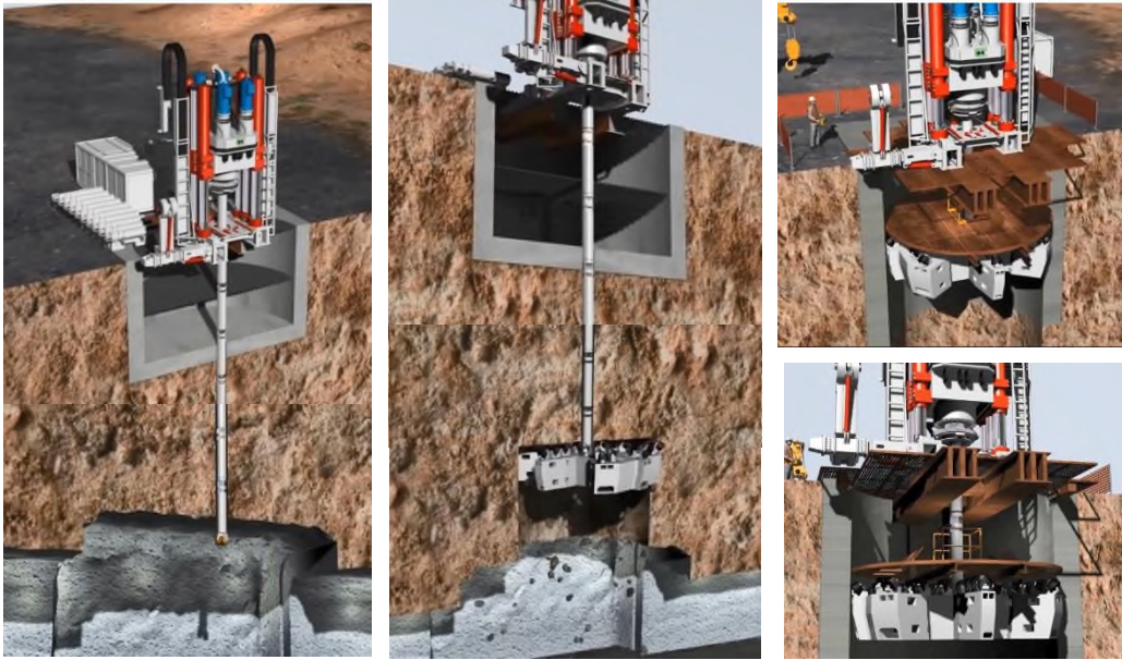
Yeni Zigana Tüneli havalandırma bacalarının imalatında uygulanan Baştüsti Delgi Yöntemi'nin şematik gösterimi
