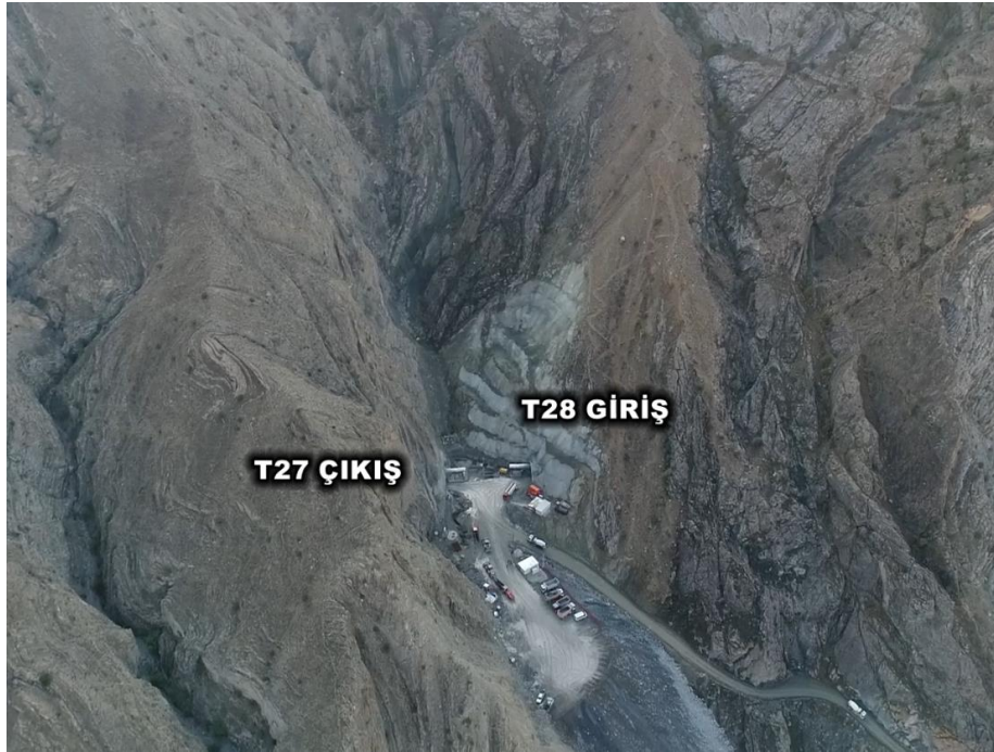
Sahada gerçekleştirilen portal imalat çalışmaları
